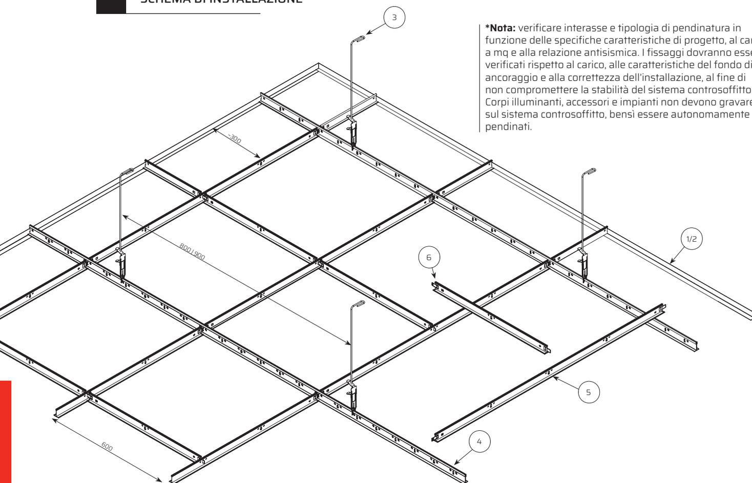
**\*Nota:** verificare interasse e tipologia di pendinatura in funzione delle specifiche caratteristiche di progetto, al carico a mq e alla relazione antisismica. I fissaggi dovranno essere verificati rispetto al carico, alle caratteristiche del fondo di ancoraggio e alla correttezza dell'installazione, al fine di non compromettere la stabilità del sistema controsoffitto. Corpi illuminanti, accessori e impianti non devono gravare sul sistema controsoffitto, bensì essere autonomamente pendinati.
