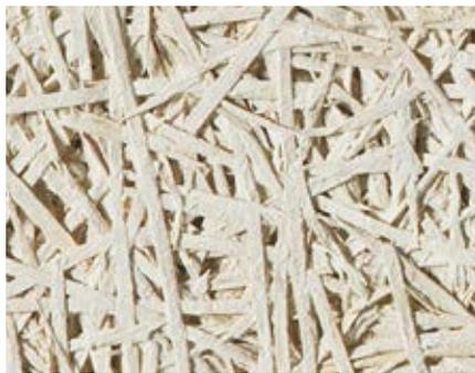
Pannello isolante termico ed acustico, in lana di legno sottile di abete rosso mineralizzata e legata con cemento Portland bianco. Larghezza lana di legno: 2 mm. Pannelli di alta qualità per sistemi di design e assorbimento acustico.
