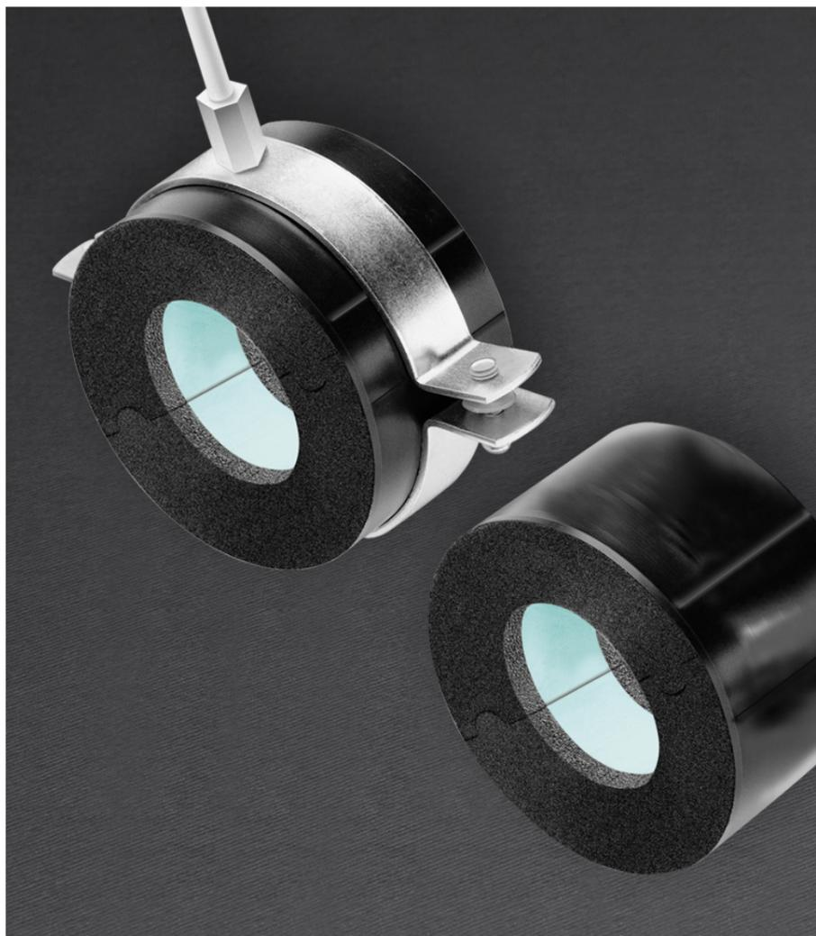
Realizzato per garantire il corretto spessore dell'isolante nei punti in cui sono previsti i fissaggi. La parte centrale in PIR, su tutta la circonferenza, unita a due corone laterali di isolante di K- FLEX, garantisce la continuità della barriera al vapore. La chiusura longitudinale è ottenuta da una sovrapposizione autoadesiva. Il rivestimento esterno è in PVC. Il supporto è disponibile anche con collarino, speciale supporto metallico che facilita le operazioni di fissaggio alle parti
