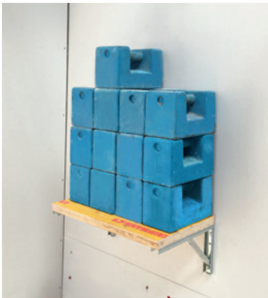
Prova di carico su mensola, oltre 200 kg applicati a singola lastra HABITO™ FORTE / HABITO™ FORTE HYDRO con tassello in acciaio tipo molly.
