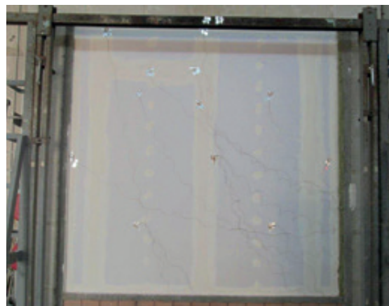
Faccia esposta al fuoco del campione prima della prova
