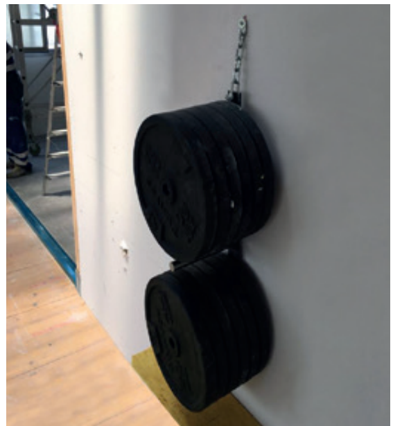
Prova di estrazione del fissaggio nel piano parallelo alle lastre (verticale - carico a taglio), oltre 100 kg applicati a singola lastra HABITO™ FORTE / HABITO™ FORTE HYDRO con vite da legno truciolare.
