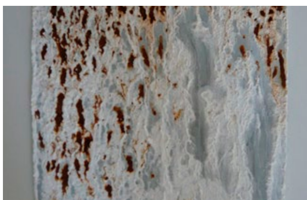
Test in nebbia salina 500 ore bordi scoperti zinco standard
