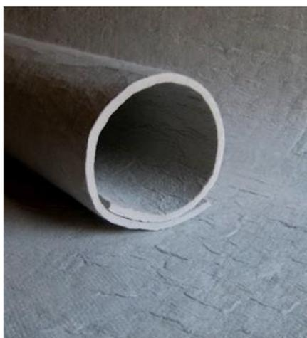
Pyrogel xtf è un materassino isolante a base di aerogel studiato per fornire la massima protezione termica a basso spessore e in presenza di alte temperature. Simile per caratteristiche al Pyrogel XTE è studiato per fornire un'eccezionale protezione contro il fuoco.
