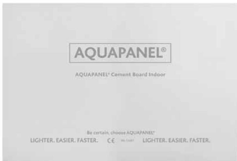
Lastra costituita da un nucleo in cemento Portland rivestito da una rete in fibra di vetro annegata nella superficie anteriore e posteriore. I bordi di testa sono squadrati e i bordi longitudinali sono rinforzati e arrotondati (EasyEdge™).
