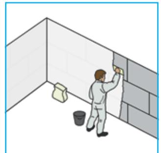
Si deve necessariamente posare la rete AQUAPANEL® Reinforcing Mesh, annegandola nel rasante AQUAPANEL® Joint Filler & Skim Coating - white. Per ottenere una finitura di Livello Q2 (finitura standard consigliata) applicare un altro strato sottile di rasante AQUAPANEL® Joint Filler & Skim Coating - white e levigare l'intera superficie.
