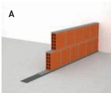
Prima di iniziare la posa di tutte le tramezzature, è necessario procedere alla posa di Isolmant Fascia Tagliamuro. Questo accessorio in polietilene espanso reticolato ad alta densità è specifico per desolidarizzare le tramezzature dal solaio contribuendo in tal modo a ridurre la trasmissione strutturale del rumore dalle pareti al solaio stesso. Tale fascia è disponibile in diversi spessori e densità in funzione del peso delle tramezzature (dis. A).
